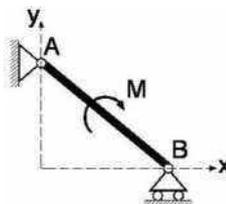
13. Указать направление опорной реакции шарнира  $A$  невесомой балки  $AB$ .
