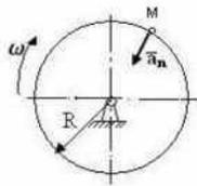
32. В кривошипно - кулисном механизме кривошип  $OM=20\text{см}$  вращается с угловой скоростью  $\omega=1\text{с}^{-1}$ . При этом ползун  $M$  движется в прорези кулисы  $AB$ , заставляя её совершать возвратно - поступательное движение. Определить скорость ползуна относительно кулисы, если  $\varphi=30^\circ$ .
