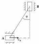
Определить угловую скорость стержня  $AB$ .
