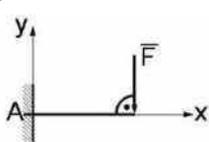
16. Указать все ненулевые реакции невесомой консольной балки, на которую действует сила  $F$  ( $X, Y$  - реакции вдоль осей  $x, y$  соответственно,  $M$  - момент заделки).
