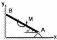
12. Невесомая балка  $AB$  длины 6 м опирается в точке  $B$  на гладкую вертикальную стену,  $M=12$  нм. Определить величину вертикальной реакции опоры  $A$  и силу давления балки на стену.
