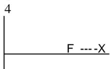
17. Указать все ненулевые реакции невесомой консольной балки, на которую действует сила  $F$  ( $X, Y$  - реакции вдоль осей  $x, y$  соответственно,  $M$  - момент заделки).
