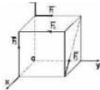
26. Силы  $F_1$  и  $F_2$ , пересекающие ось  $Z$ , параллельны соответственно осям  $OY$  и  $OX$ . Сила  $F_3$  лежит в плоскости  $XOY$  и составляет угол  $\alpha$  с осью  $OY$ . Расстояния  $a$ ,  $b$ ,  $c$ ,  $e$  показаны на рисунке. Определить проекцию на ось  $X$  главного момента сил.
