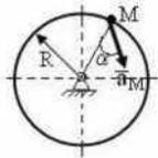
20. Ускорение точки **M** диска, вращающегося вокруг неподвижной оси  $a_M = 4 \text{ м/с}^2$ . Опре-
