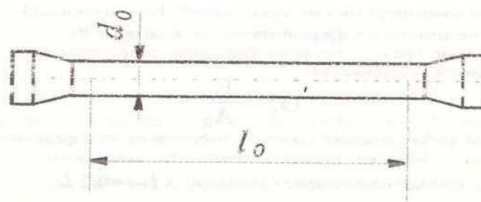
Рис. 1 Стандартный образец для испытания стали на растяжение
