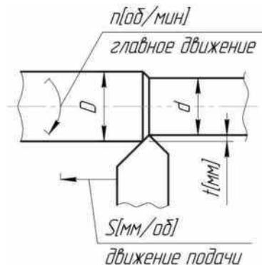
Рис. 1 - Эскиз элементов режима резания при обтачивании
